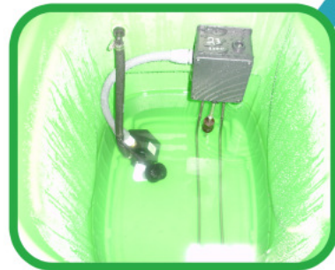
Vorratsbehälter mit Pumpe & Heizung
